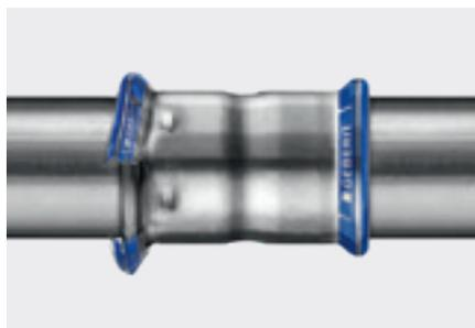
Les indicateurs colorés identifient les raccords Mapress non sertis avant même le test de pression.
