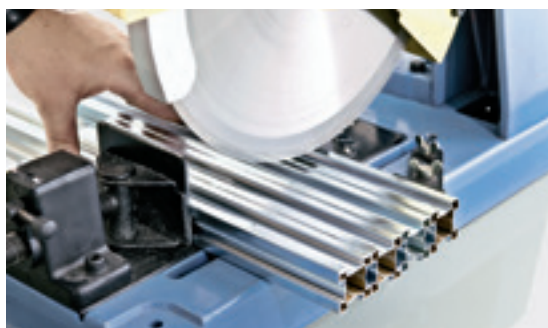
↑ Une scie à onglet peut couper jusqu'à quatre profilés Geberit GIS à la bonne longueur en même temps.
